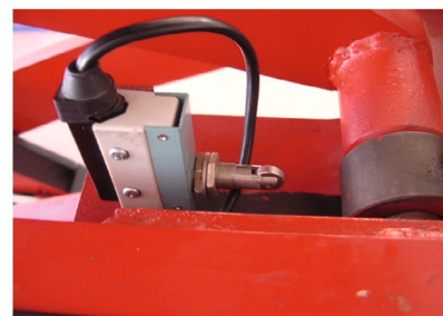
Image 24 : (Interrupteur de fin de course supérieur secondaire)
